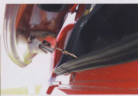
Frische Luft kommt hinein, der Hund aber nicht hinaus: Abstandshalter, der im Schloss einrastet – eine genial einfache Idee
